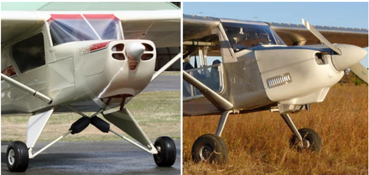
Obr. 6.9 (zleva) Podvozkové zařízení Mavericka s gumovými provazci a Rebela ve verzi s pružinovými nohami [53], [37]
