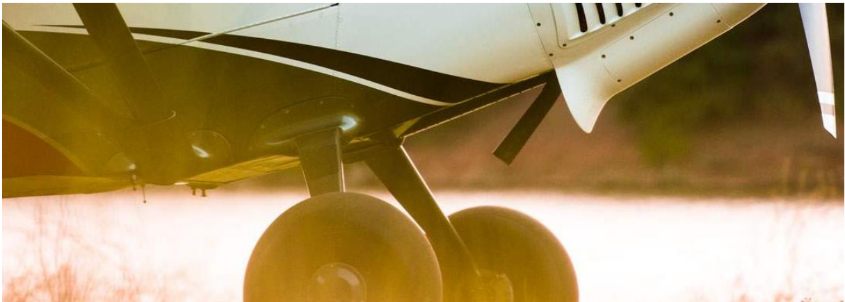
Obr. 6.9 Kompozitové kryty přechodů podvozek-trupu a vzpěra-trupu letounu Xcub [84]
