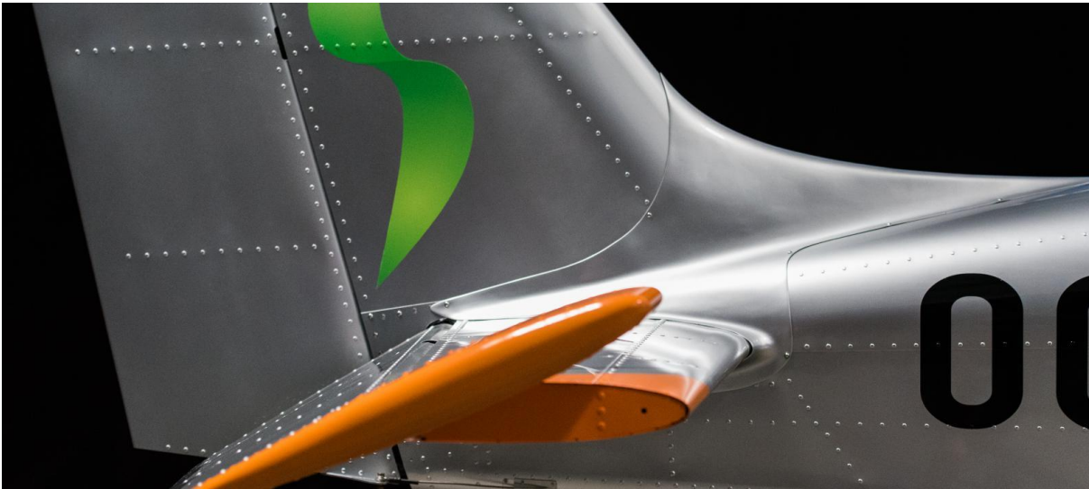
Obr. 6.10 Kryt z hliníkové slitiny na přechodech OP-trup letounu Sonaca 200 [20]
