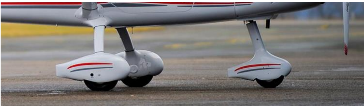
Obr. 3.6.2.1 Přistávací zařízení letounu TL-3000 Sirius [66]
