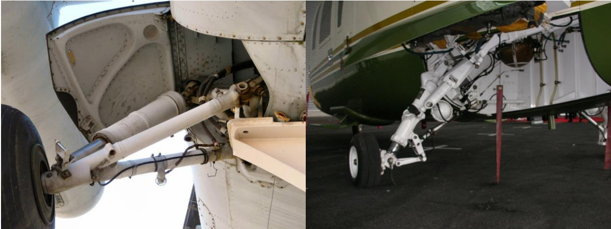
Obr. 3.6.4.9 Podvozky vrtulníků Mi-24 a S-76 [44, 40]
