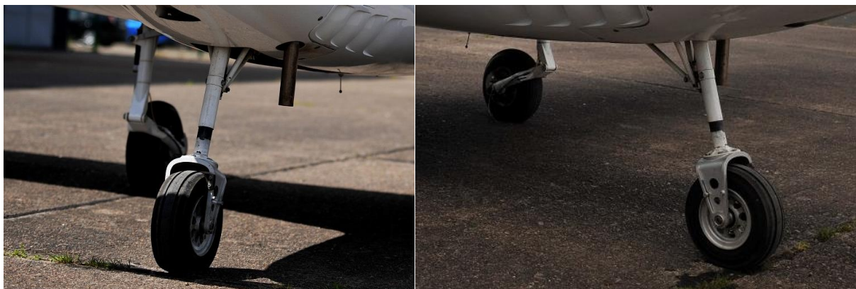
Obr. 3.6.3.1 Detail přední podvozkové nohy letounu TL-Stream [66]
