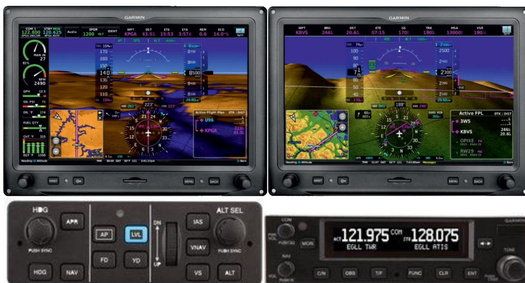
Obr. 4.3.1 Dvojice přístrojů G3X, panel autopilota GMC 307 a rádio GNC 255 [34]
