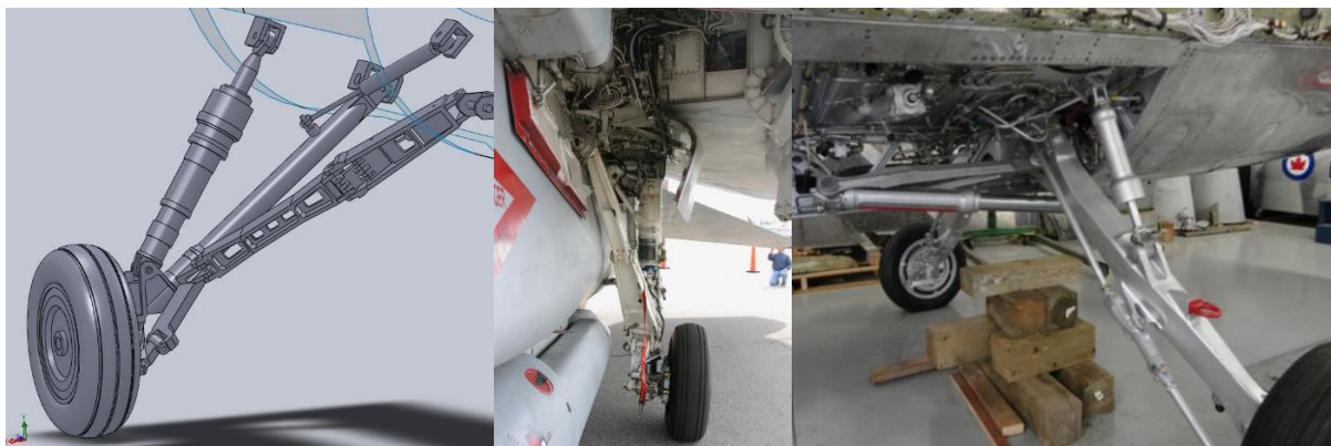
Obr. 3.6.4.7 Zatahovací podvozky letounů F-16, F-14 a F-104 [38, 42, 26]
