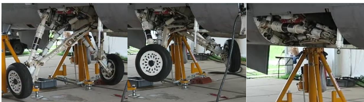
Obr. 3.6.4.8 Fáze zatahování podvozku F-16 Fighting Falcon [31]
