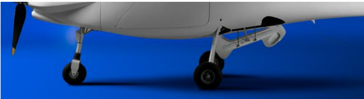
Obr. 3.6.4.6 Řešení zatahovacího podvozku na letounu Evolution [29]
