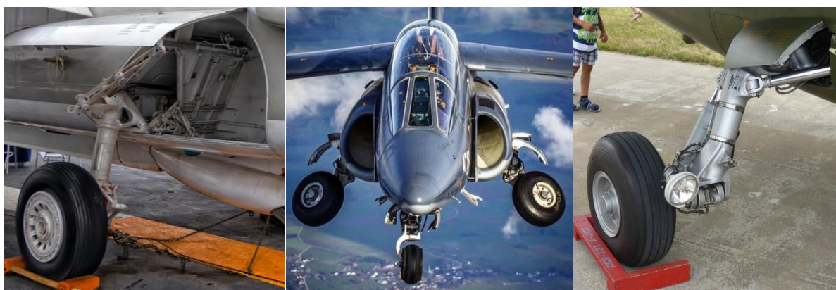
Obr. 3.6.4.15 Podvozky letounů Douglas A-3 Skywarrior a Alpha jet [70, 20, 19]
